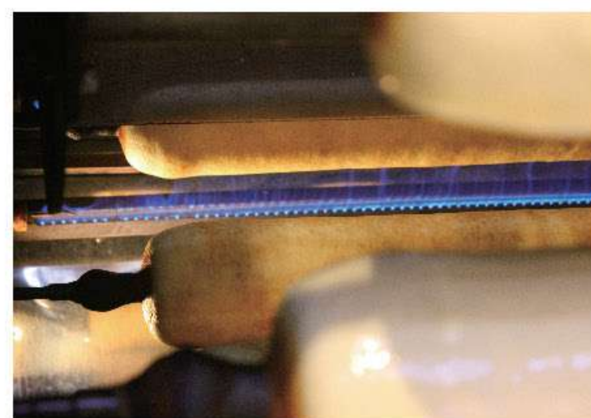
生地がぬられた焼き棒は、 回転しながらオープンのお くへ入っていくよ。
