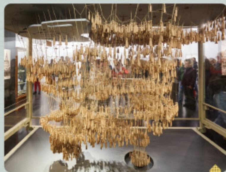
サグラダ・ファミリアの展示室には、コロニア・グエル教会堂の逆さ吊り実験の模型が復元されている。オランダ・ドイツチームが制作したもので、オリジナルの3分の2の大きさ（写真：Javier Larrea Roa/アフロ）。
