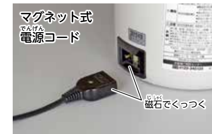
磁石でくっつけば、あやまって電源コードに足をひっかけたときでもはずれるので、本体がたおれず、安全性が高い。
