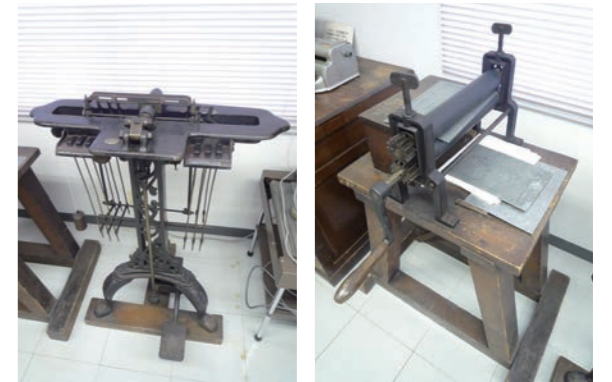
ライトハウスの開館当時に使われた点字製版機（左）と点字印刷機（右）。
