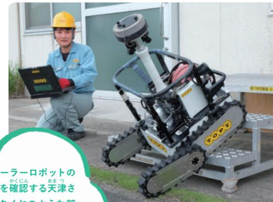
クローラーロボットの動きを確認する天津さん。タイヤのような部分がクローラーで、階段の上り下りもできる。
