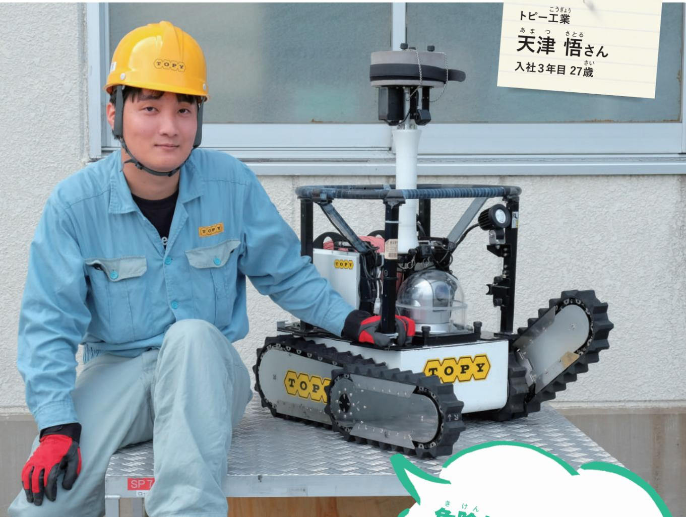
災害対応ロボットは、危険な場所で人の代わりに作業するロボットです。なかのようすをカメラで撮ったり、なかからものを運び出したりと、さまざまな作業を行います。トピー工業で災害対応ロボットの設計を行う、天津悟さんにお話をうかがいました。
