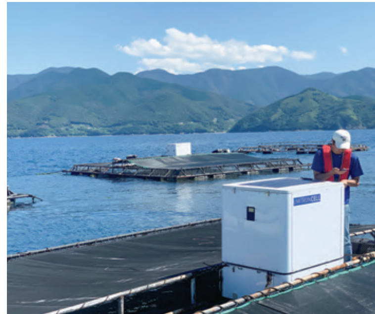
▲養殖場で活用されている自動給餌機(写真奥と手前の白い機械)。
